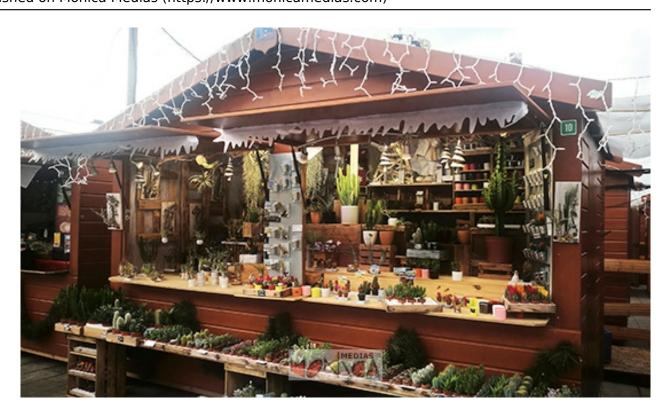
Le chalet de Noël frenchy easy à monter en un quart d'heure réunit tous les points techniques de base garantissant la sécurité du public et des commerçants: traitement du bois, assemblage rapide par clavettes, volets et portes renforcées par cornières en acier thermolaquées, ouverture et fermeture des volets par vérin à gaz, serrure et poignées ergonomiques, verrouillables ou cadenassables et plancher en bois servant de palette de stockage
