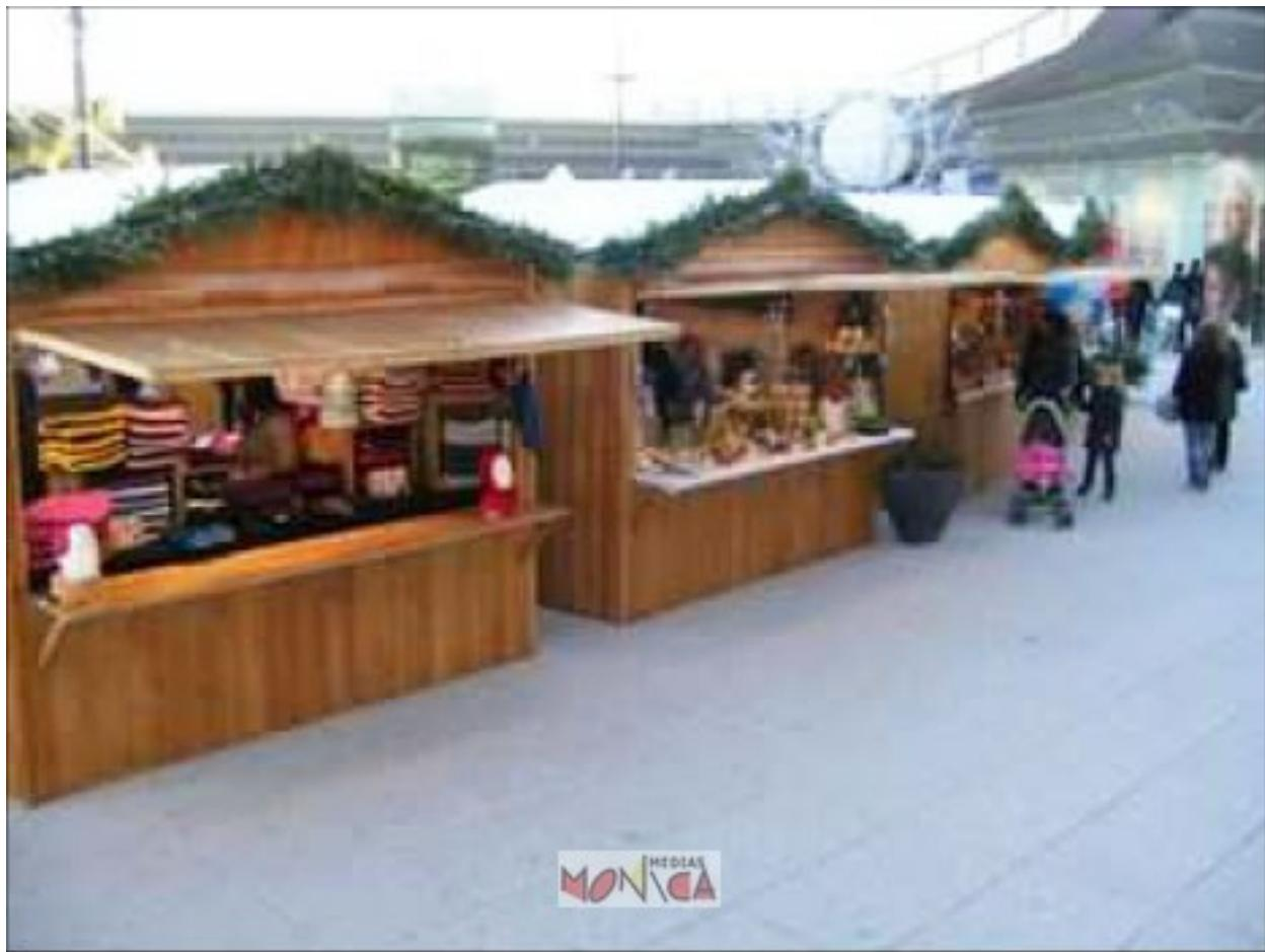
Façade : panneau de 3 m de long x 2,20 m de hauteur ; partie basse de 2,56 m de long x 0,90 m de hauteur ; partie haute de 2,56 m de long x 1,10 m de hauteur en auvent rabattable muni de deux vérins hydrauliques ; comptoir monté sur équerres de 2,56 m x 0,40 m ; planche de 30 mm d'épaisseur.
